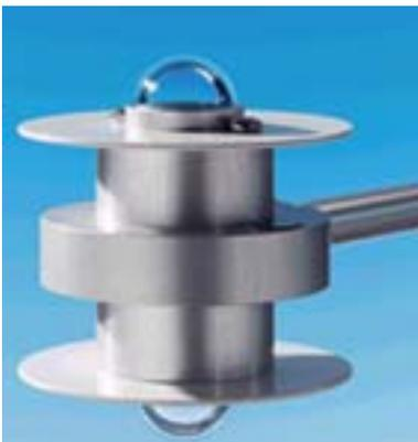
Delta Ohm produce dos modelos de albedómetros: LP PYRA 05 construido partiendo de dos piranómetros de 1<sup>ª</sup> Clase \* y LP PYRA 06 construido partiendo de dos piranómetros de 2<sup>ª</sup> Clase\* (\* según la norma ISO 9060 y las recomendaciones del WMO Organización Mundial de Meteorología).
