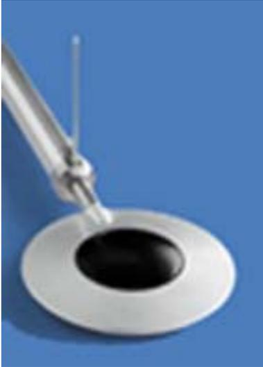
El net-radiómetro LP NET 07 mide la radiación neta a través de una superficie, en un espectro que va desde el ultravioleta más corto, hasta el infrarrojo más largo. Se entiende por radiación neta la diferencia entre la que llega a la superficie superior, y la que llega a la superficie inferior.
