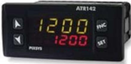
Este controlador 32x74 con doble display a 4 cifras se caracteriza por su elevada configurabilidad y alimentación multi-tensión de 24 a 230 Volt AC/DC aislada galvánicamente que no requiere de una selección hardware, lo cual se traduce en un número reducido de códigos de productos. La entrada es programable para sensores de temperatura, termorresistencias y termopares, como así también para sensores de presión, humedad y flujo.
