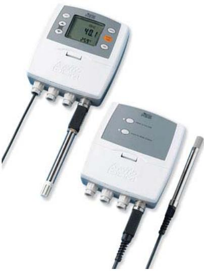
Los instrumentos de las series HD2717T.. y HD2817T... son transmisores de señal de humedad y temperatura, que en función del modelo, actúan como indicadores, reguladores on/off y datalogger. Tienen una pantalla LCD retroiluminada de 128x64 pixels.
