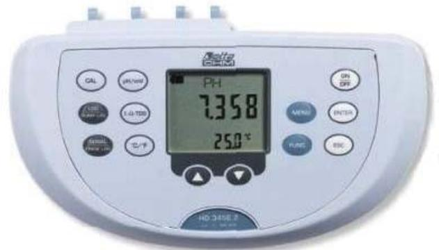
**El HD3456.2** mide el pH, los mV, el potencial de óxido-reducción (ORP), la conductividad, la resistividad en los líquidos, los sólidos totales disueltos (STD) y la salinidad con sondas combinadas de conductividad y temperatura de 2 y 4 anillos. Además, mide sólo la temperatura con sondas de inmersión, penetración o contacto con sensor Pt100 ó Pt1000.
