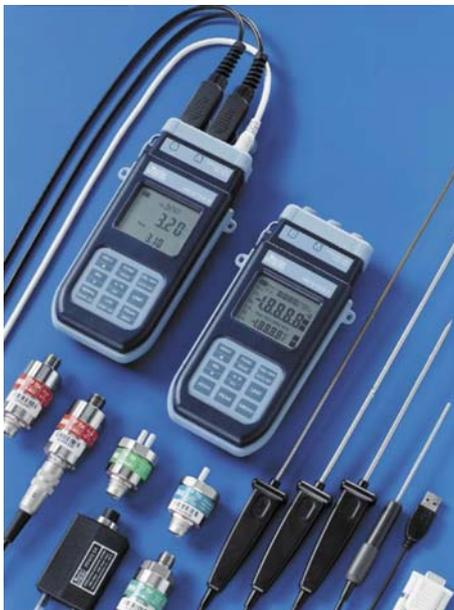
El HD2124.1 y el HD2124.2 son instrumentos portátiles con dos entradas con visualizador LCD de grandes dimensiones, que efectúan medidas de presión absoluta, relativa y diferencial, y medidas de temperatura.
