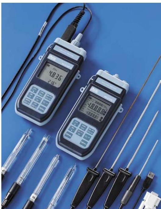
El instrumento HD2105.2 es un datalogger, memoriza hasta 34.000 muestras de pH y temperatura que se pueden transferir a un PC conectado al instrumento mediante el puerto serie multi-estándar RS232C y USB 2.0. Desde el menú es posible configurar el intervalo de memorización, la impresión y el baud rate.
