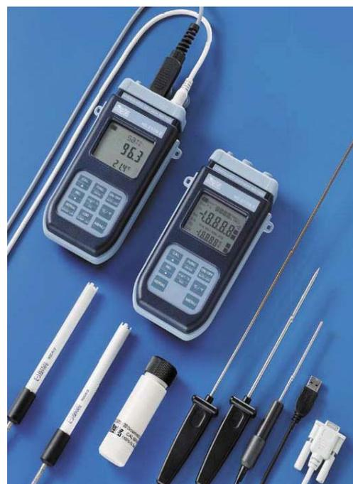
El HD2109.1 y el HD2109.2 son instrumentos portátiles con visualizador LCD de grandes dimensiones. Miden la concentración del oxígeno disuelto en los líquidos (en mg / l), el índice de saturación (en %) y la temperatura con sondas combinadas SICRAM de tipo polarográfico de dos o tres electrodos y sensor de temperatura integrado.
