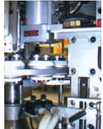
Aplicación de 2 HOT AIR TOOLS en el precalentamiento previo de tubos para su soldadura en la industria cosmética
