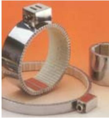
Resistencia blindada, no estanca, con envoltorio exterior en plancha de acero y elemento calefactor montado sobre elementos cerámicos.
