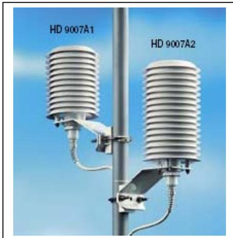
Estos protectores se usan para preservar las sondas de temperatura y temperatura-humedad, de las estaciones meteorológicas, de las radiaciones solares, de la lluvia y del viento.
