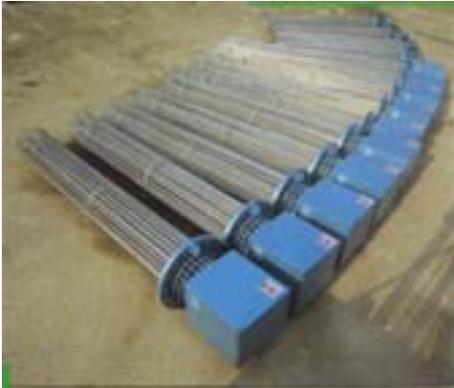
Están diseñados para el calentamiento y mantenimiento de la temperatura de fluidos líquidos o gaseosos en grandes volúmenes, ya sea en reposo, o en circulación. De aplicación en fluidos líquidos o gaseosos.
