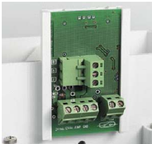
Fig. 3 Caja de conexiones eléctricas
