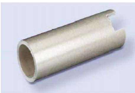
Su uso reduce las pérdidas caloríficas, en el cuerpo de la boquilla en un 60%. Aumenta el diámetro exterior de la boquilla en 11 mm. Solo debe cubrir el cuerpo de la boquilla.
