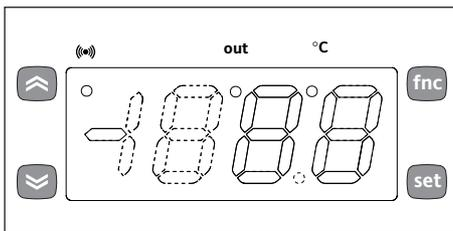
Al encenderse el instrumento se realiza un Chequeo de Pilotos; durante algunos segundos el display y los leds parpadean, comprobando la integridad y buen funcionamiento de los mismos. El instrumento dispone de dos Menús principales, el Menú del “Estado de máquina” y el Menú de “Programación”.
