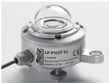
La sonda LP PHOT 02 mide la luminancia (lux) definida como la relación entre el flujo luminoso (lumen) que atraviesa una superficie, y el área de esta superficie (m<sup>2</sup>).
