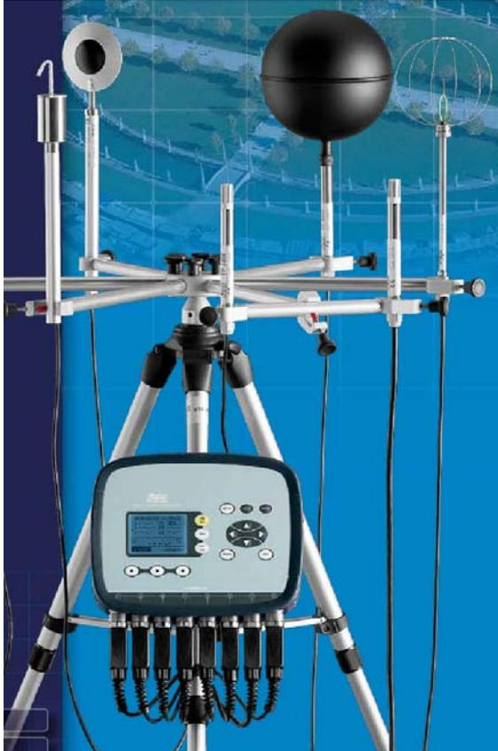
El **HD32.1, Thermal Microclimate** es un instrumento fabricado por Delta Ohm Srl para el estudio, la medida y el control del Microclima en los puestos de trabajo, de acuerdo con las normas siguientes:
