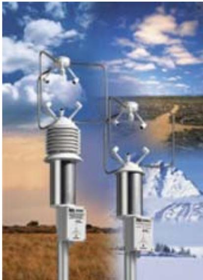
Los instrumentos HD 2003, HD 2003.1 son anemómetros a ultrasonidos de 3 ejes, miden la velocidad y dirección del viento, las componentes cartesianas U - V - W de la velocidad, la velocidad del sonido y la temperatura sónica.
