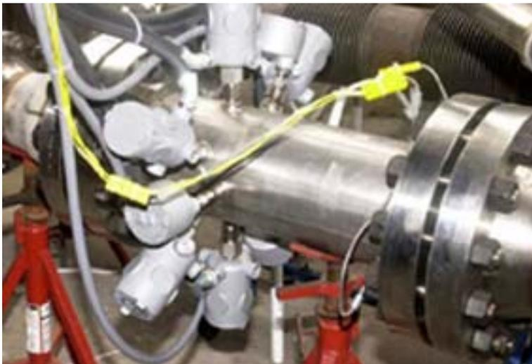
FLANGED INLINE HEATER como fuente de aire caliente en un banco de pruebas
