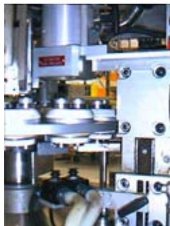
Aplicación de 2 HOT AIR TOOLS en el precalentamiento previo de tubos para su soldadura en la industria cosmética
