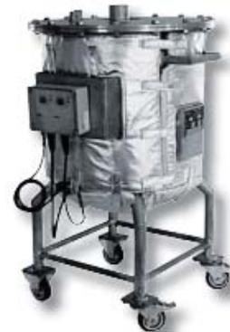
Aquí la camisa calefactora desmontable se adapta con aislamiento térmico y control de temperatura al tanque móvil.
