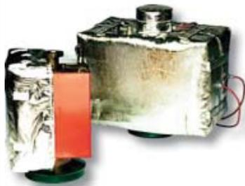
Estas bombas de alto vacío se calientan a 350 ° C con una funda calefactora desmontable. El requisito es una distribución uniforme del calor sobre toda la superficie.
