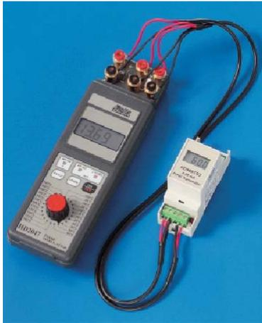
El HD 2047 es un instrumento portátil, especialmente estudiado para el control y la calibración de instrumentos con entrada del tipo Pt 100 y salidas de tensión o de corriente.
