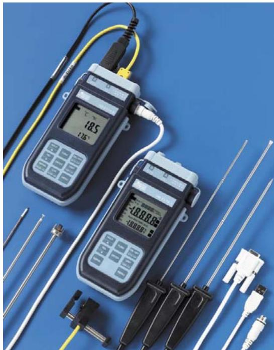
El **HD2178.1** y el **HD2178.2** son instrumentos portátiles con visualizador LCD de grandes dimensiones. Miden la temperatura con sondas de inmersión, pincho, contacto o ambiente con sensor RTD o termopar.
