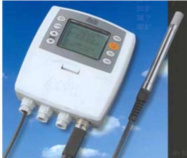
Los modelos HD2817T..incorporan un display gráfico LCD retroiluminado (128x64 pixel) que visualiza simultáneamente 3 magnitudes físicas, y un gráfico en tiempo real que visualiza una de las magnitudes medidas. La función datalogger permite memorizar las mediciones obtenidas, con una cadencia preestablecida por el usuario. La configuración del instrumento se memoriza de forma permanente. El reloj interno está protegido por una batería de litio para prevenir los fallos de alimentación de red.
