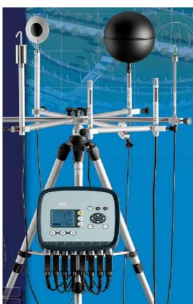
El **HD32.1, Thermal Microclimate** es un instrumento fabricado por Delta Ohm Srl para el estudio, la medida y el control del Microclima en los puestos de trabajo, de acuerdo con las normas siguientes:
