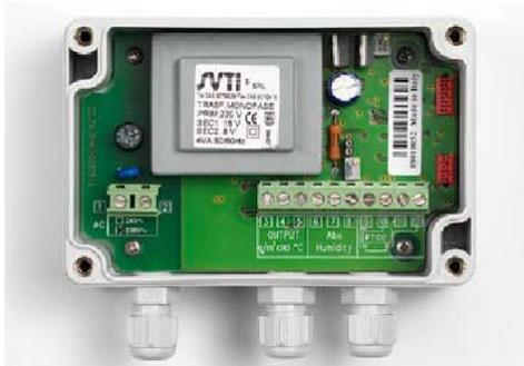
El HD3817T... y el HD38V17T... son transmisores activos de humedad absoluta y de temperatura de doble canal con salidas de corriente 4...20mA o de tensión 0...10Vdc, respectivamente.
