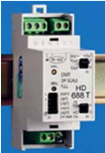
El transmisor HD 688T está construido en una caja de 2 módulos DIN para guía asimétrica de 35 mm. El módulo convierte la señal proveniente de una sonda Pt100 de 3 hilos en una señal analógica que puede seleccionarse a través de un conector puente entre 0÷20 mA, 4÷20 mA, 0÷10 V.
