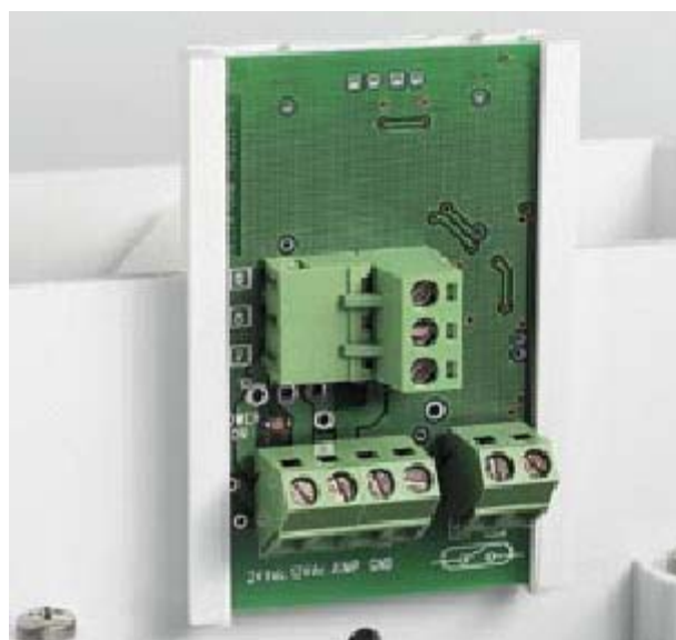
Fig. 3 Caja de conexiones eléctricas
