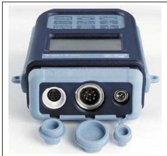
El **HD2106.1** y el **HD2106.2** son instrumentos portátiles con visualizador LCD de grandes dimensiones. Miden la conductividad, la resistividad en los líquidos, los sólidos totales disueltos (TDS) y la salinidad con sondas combinadas de conductibilidad y temperatura de 2 y 4 anillos. Miden sólo la temperatura con sondas con sensor Pt100 o Pt1000 de inmersión, pincho o contacto.
