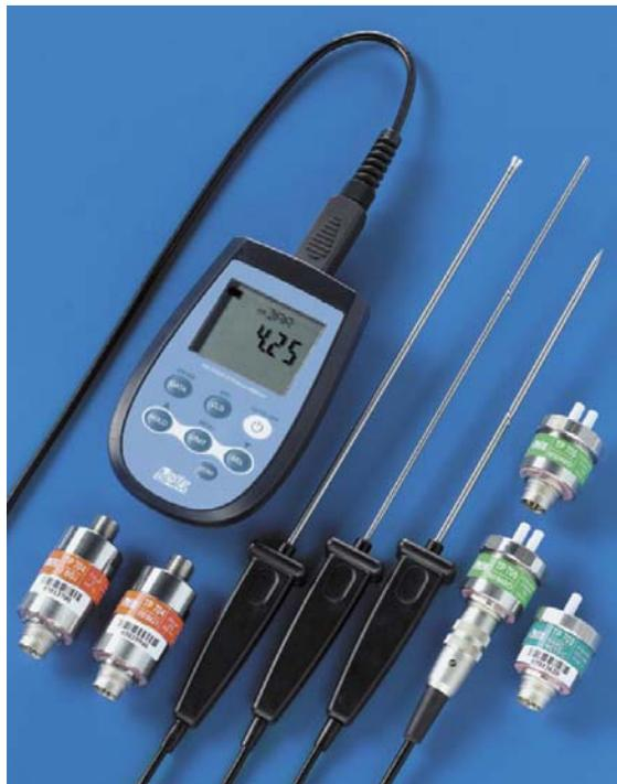
El **HD2304.0** es un instrumento portátil de dos ingresos con visualizador que efectúa medidas de presión absoluta, relativa y diferencial, y medidas de temperatura.
