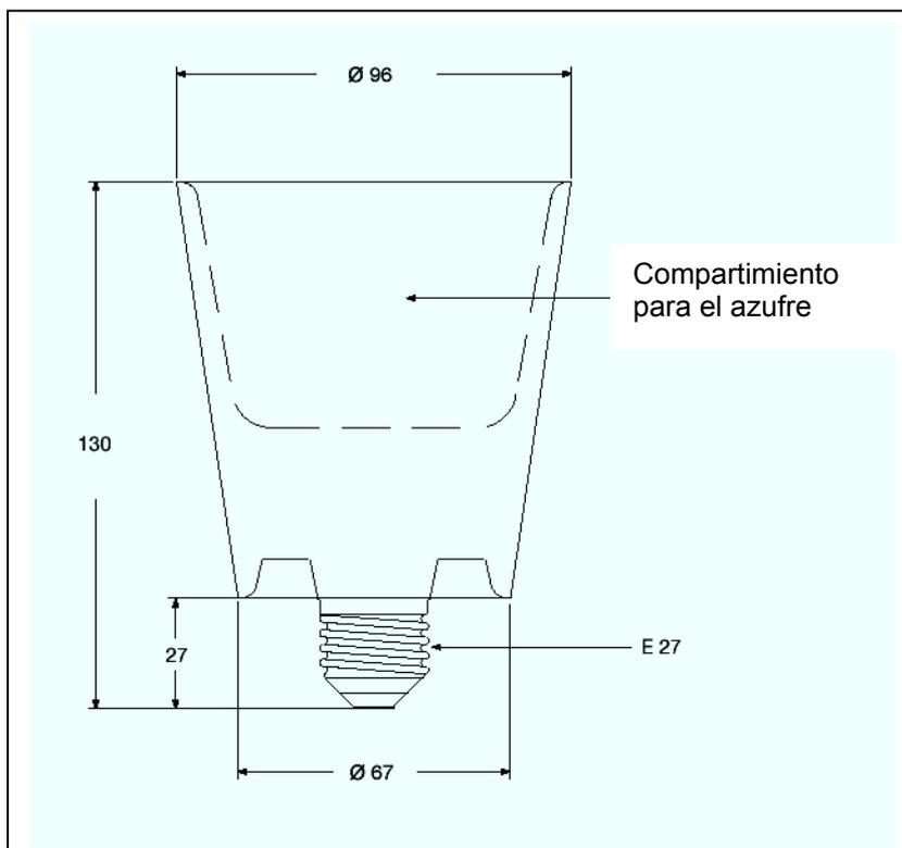
El evaporador de azufre SSV se suministra con una potencia de 75W a 230V
