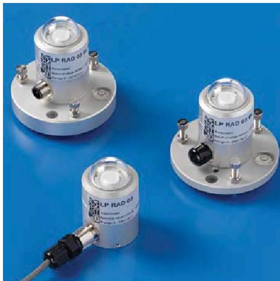
La serie de sondas LP...03 **para exteriores** permite medir las magnitudes fotométricas y radiométricas, como: la iluminación, la irradiación ( $w/m^2$ ) en las zonas de espectro visible, UVA, UVB y el número de fotones para unidad de tiempo y superficie en la zona de PAR (400 nm ÷ 700 nm).
