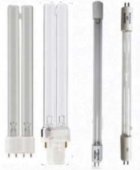
Las lámparas germicidas proporcionan una fuente altamente eficiente de luz UV para aplicaciones médicas y comerciales. Están disponibles en formatos con conexión en un solo extremo y en los dos extremos. Se pueden suministrar con bases G10.2q, G5, G13, G23 y 2G11. Son de vapor de mercurio a baja presión para producir luz UV a 253,7 nm que es muy eficaz para los usos germicidas.
