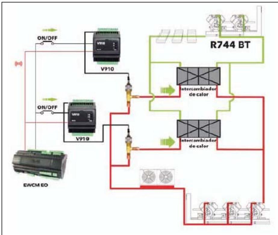
Un ejemplo típico de su aplicación: el control de la inyección de líquido para centrales EWCM EO en cascada utilizando una válvula bipolar serie SXVB controlada por un módulo V910.
