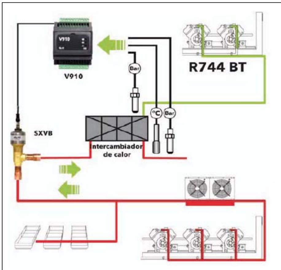
El driver V910 modula mediante la válvula SXVB la inyección de líquido en el intercambiador y condensa el refrigerante CO2 de la central de compresores R744 RT
